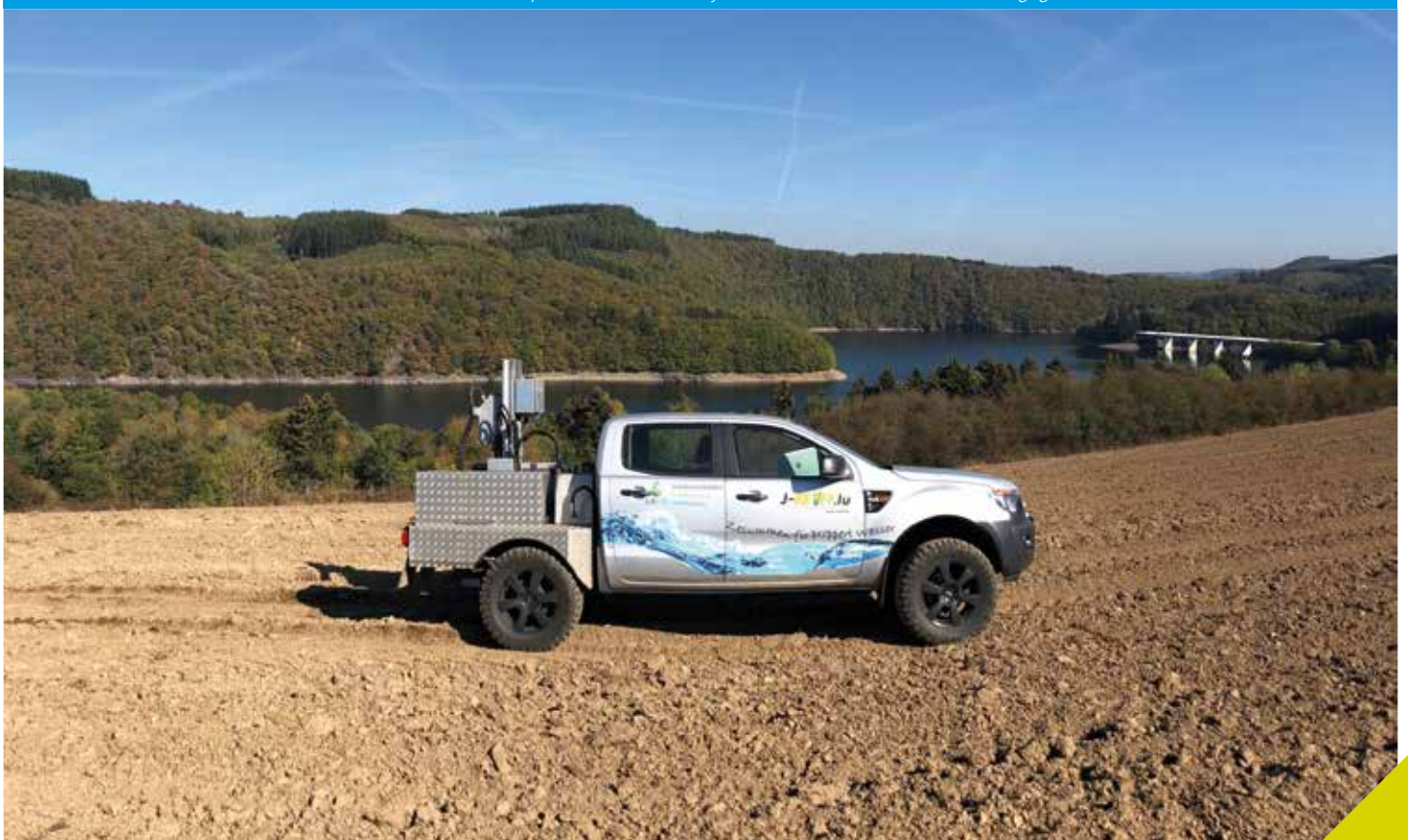
Der automatisierte Bodenprobenstecher zieht jährlich über 1200 Proben im Einzugsgebiet
