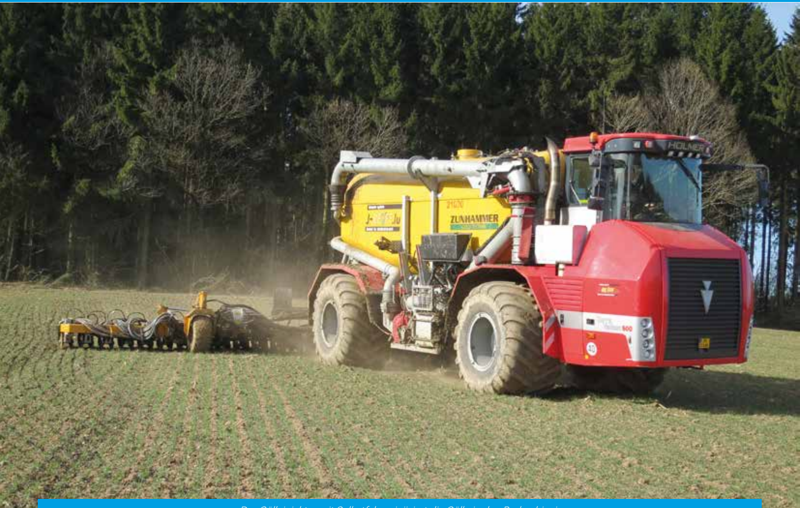
Der Gülleinjektor mit Selbstfahrer injiziert die Gülle in den Boden hinein
